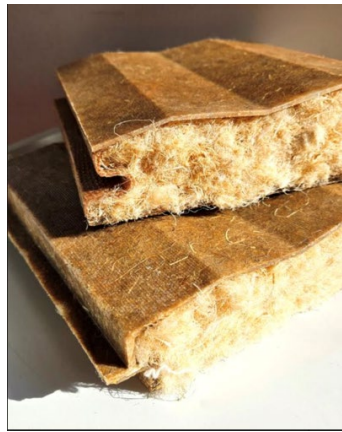
Şekil 3: Rensselaer Politeknik Enstitüsü Mimarlık, Bilim ve Ekoloji Merkezinde yapılan araştırmalar sonucunda üretilen endüstriyel kenevir yalıtım paneli iç mekânda enerji kullanımını %15-25 azaltacağı açıklanmıştır. (URL 4- 12.12.2023 tarihinde erişilmiştir.)
